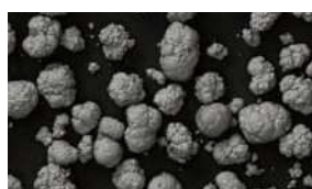
FLASH pearl (炭酸カルシウム) 平均粒子径54 \mu m SEM画像(×150)
